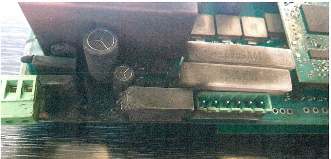
Obr. 1 - zničený rádiový modul Rx HF14b po zásahu výboje
